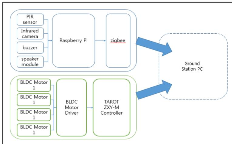
**Figure 14. UAV System Diagram**
