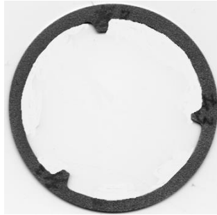
Φιγυρε 9. Της σαμπλε πιεχε οφ EXM φορ ιννερ χαπιτσοφ γυν βαρρελ χηαμβερ
